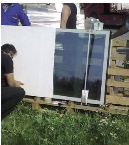
Slika 6 • Preizkus tankih vmesnih stekel pri QATT7 na temperaturne napetosti delno senčenega panela smo opravili 21. junija 2012 okoli 11. ure dopoldne pri temperaturi okolice 31 °C. Preizkusna stekla so bila obrnjena proti soncu in nagnjena nazaj za 20°. Pri preizkusu smo naredili polovični senci, kot je prikazano na sliki (levo in desno), vsako po najmanj 30 minut, tako da so se lahko na notranjih tankih steklih ustvarile največje temperaturne napetosti
