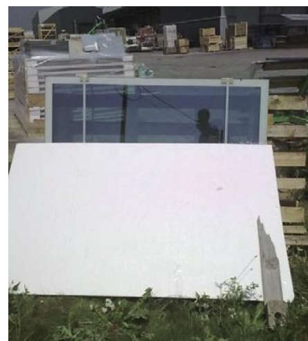
Slika 6 • Preizkus tankih vmesnih stekel pri QATT7 na temperaturne napetosti delno senčenega panela smo opravili 21. junija 2012 okoli 11. ure dopoldne pri temperaturi okolice 31 °C. Preizkusna stekla so bila obrnjena proti soncu in nagnjena nazaj za 20°. Pri preizkusu smo naredili polovični senci, kot je prikazano na sliki (levo in desno), vsako po najmanj 30 minut, tako da so se lahko na notranjih tankih steklih ustvarile največje temperaturne napetosti
