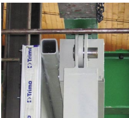
Slika 10 • Detajl členkastega vozlišča ter pritrditve lege in panela
