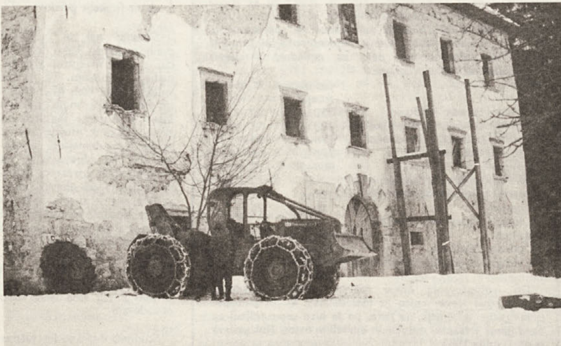
Sodobni zgibni traktor za spravilo lesa ob gradu Prežek (Foto J. Penca).
