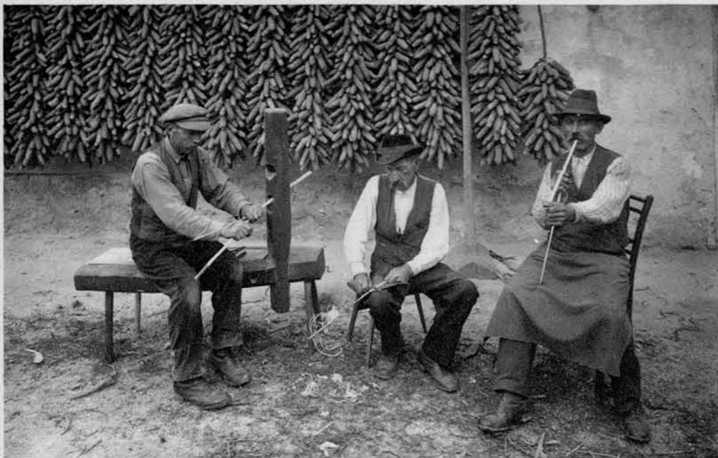
Začetek rešeta — Od leve na desno: prvi kolje vitre na stolu v babi, drugi strže vitre, tretji jih pa dere in cepi z zobmi.
