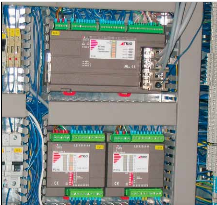
Slika 10. Pozicijski krmilnik Trio Motion Technology MC 206X z dvema razširitvenima I/O-moduloma izvaja večino časovno kritičnih funkcij vezilnega stroja.
