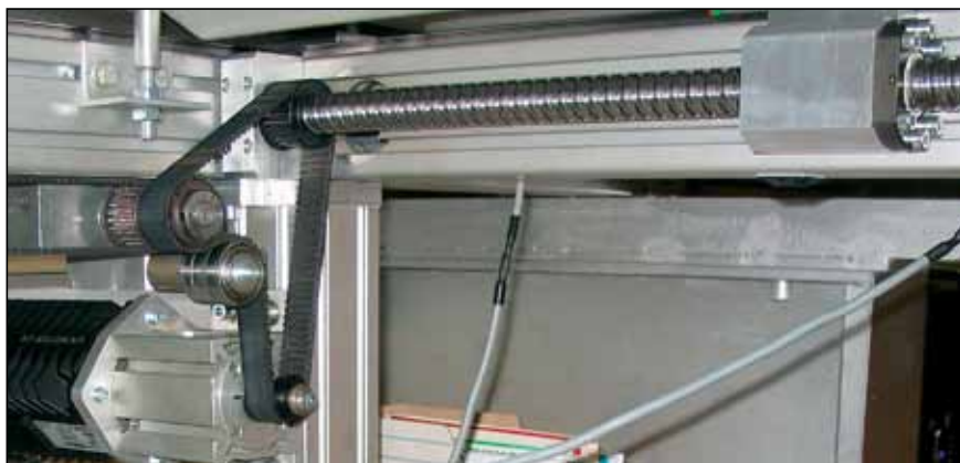
Slika 9. Pogon osi Y po vgradnji navojnega vretena
