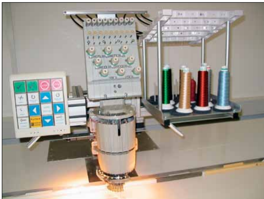
Slika 4. Vezilna glava z devetimi iglami in avtomatično menjavo. V zgornjem delu je sistem za napenjanje s kontrolo pretrganja niti, levo je upravljalni panel stroja.
