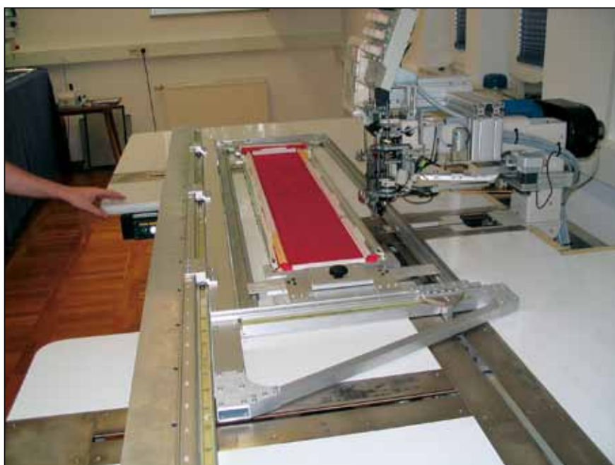
Slika 3. Stroj za vezenje med predelavo: okvir s tkanino je v srednjem delu slike, odprta vezilna glava zgoraj desno.
