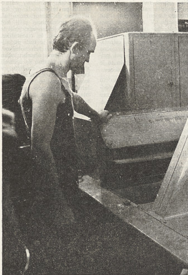
Mehanska zaščita preprečuje čiščenje čistilnih valjev med obratovanjem stroja. Iglaste valje čistimo le med mirovanjem strojev.
