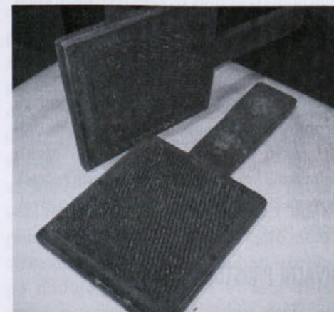
Takoimenovane »gredese«, orodje za »razčesavanje« ovčje volne, da jo je predica potem pri preji na kolovratu lažje uravnavala v enakomerno debelo nit. (Foto: Janko Rupnik)
