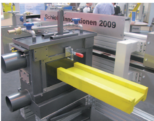
□ SCHIELE - Vakuumat za lakiranje I nosilcev
