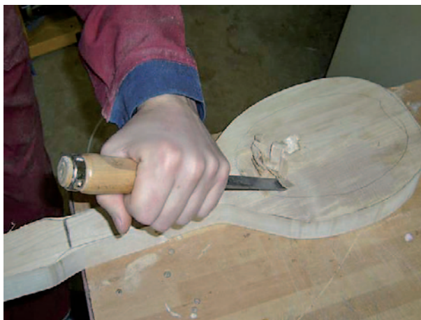
□ Slika 1. Druga stopnja izdelave tamburice - obdelava trupa.
