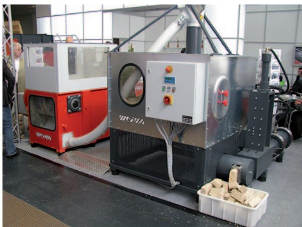
□ WEIMA - povezava stroja za drobljenje in stroja za briketiranje
