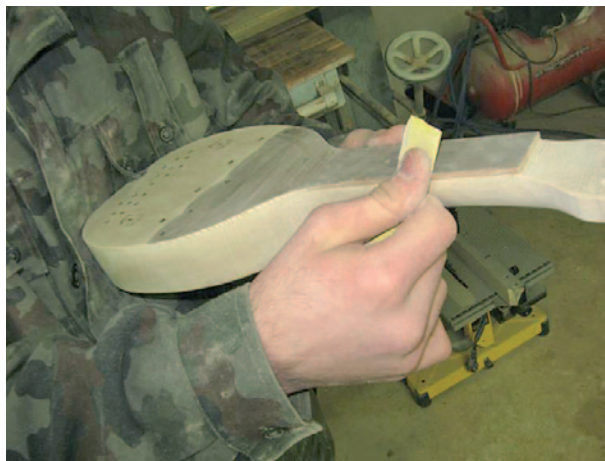
□ Slika 2. Brušenje, glajenje tamburice
