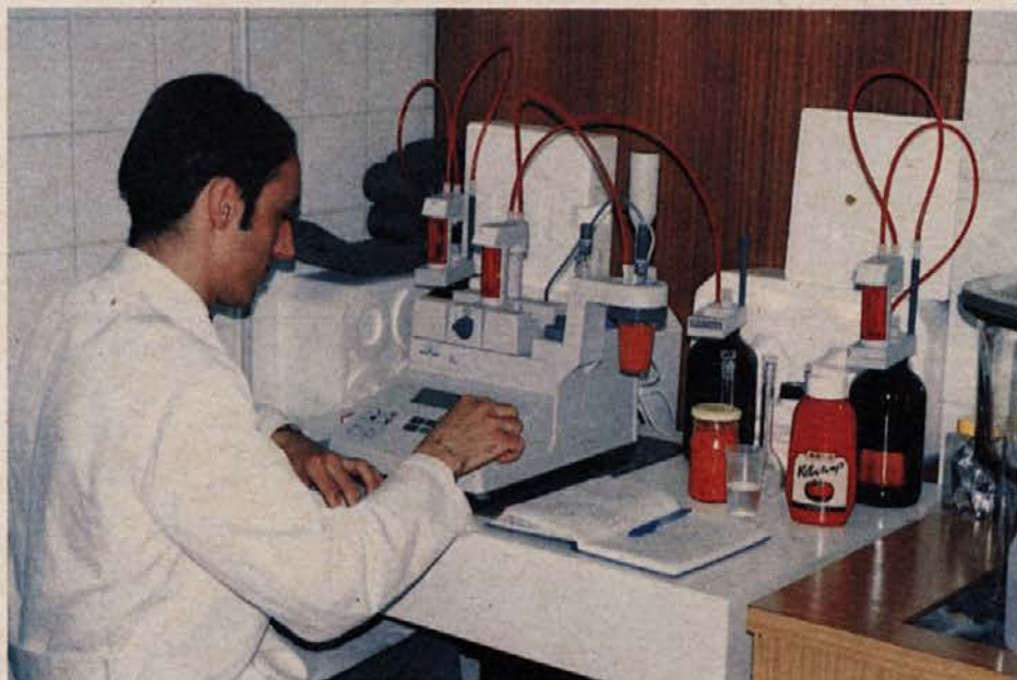
Aljoša določa vsebnost soli v ajvarju z avtomatskim titratorjem
