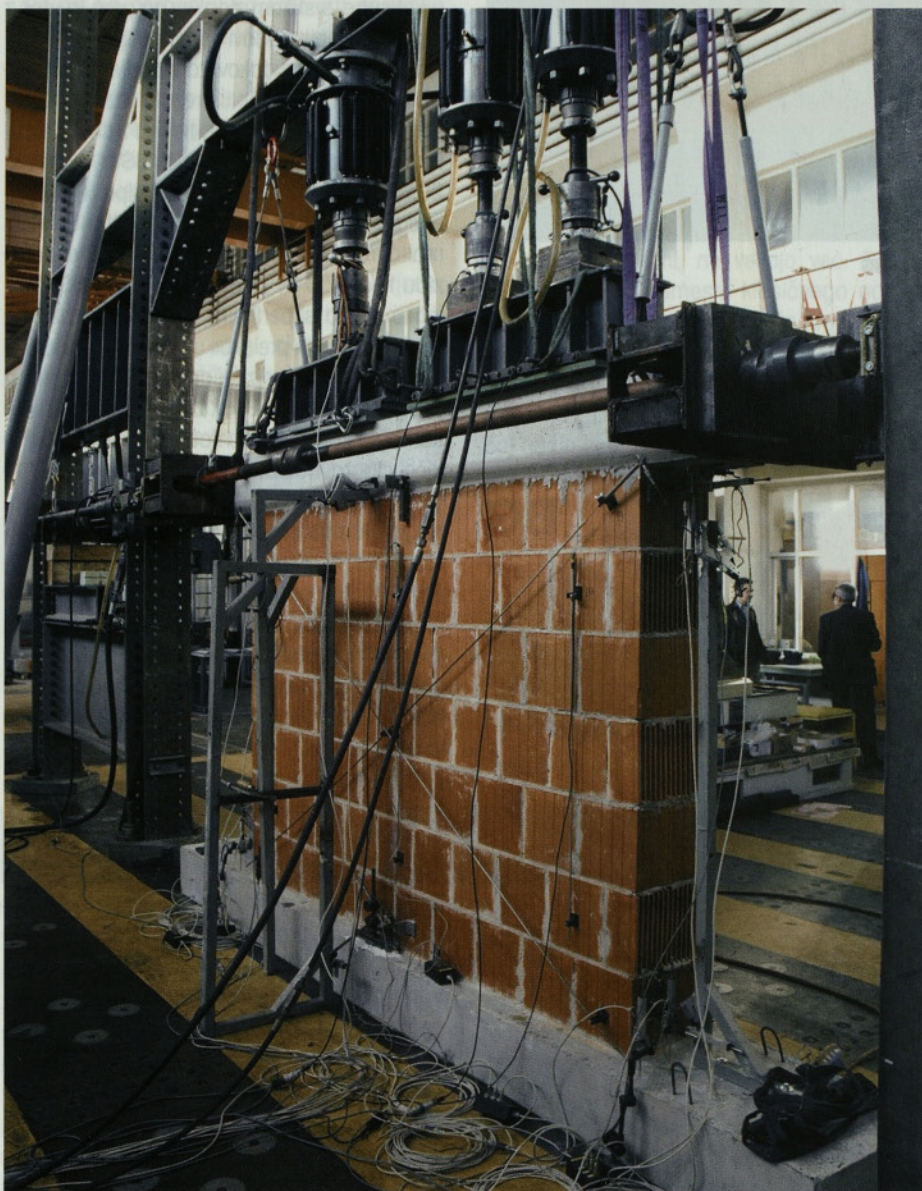
Slika 3 • Tipični zid z razmerjem oblike h/l = 0,7 med ciklično strižno preiskavo
