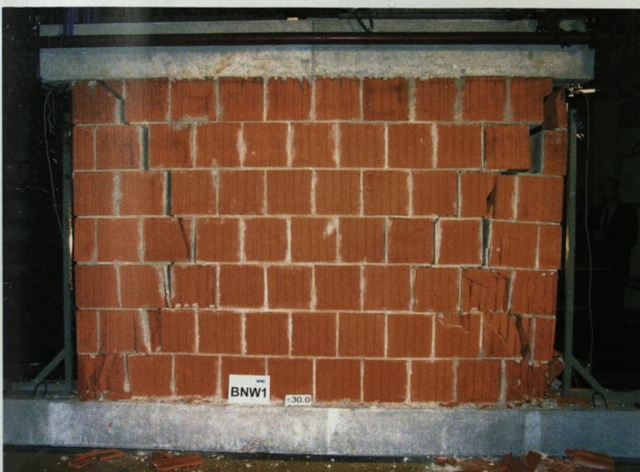
Slika 6 • Zid BNW1: porušitev zidu zaradi odpadlih s poševno razpoko ločenih robnih delov zidu pri predobremenitvi \sigma_o/f_k = 0,14
