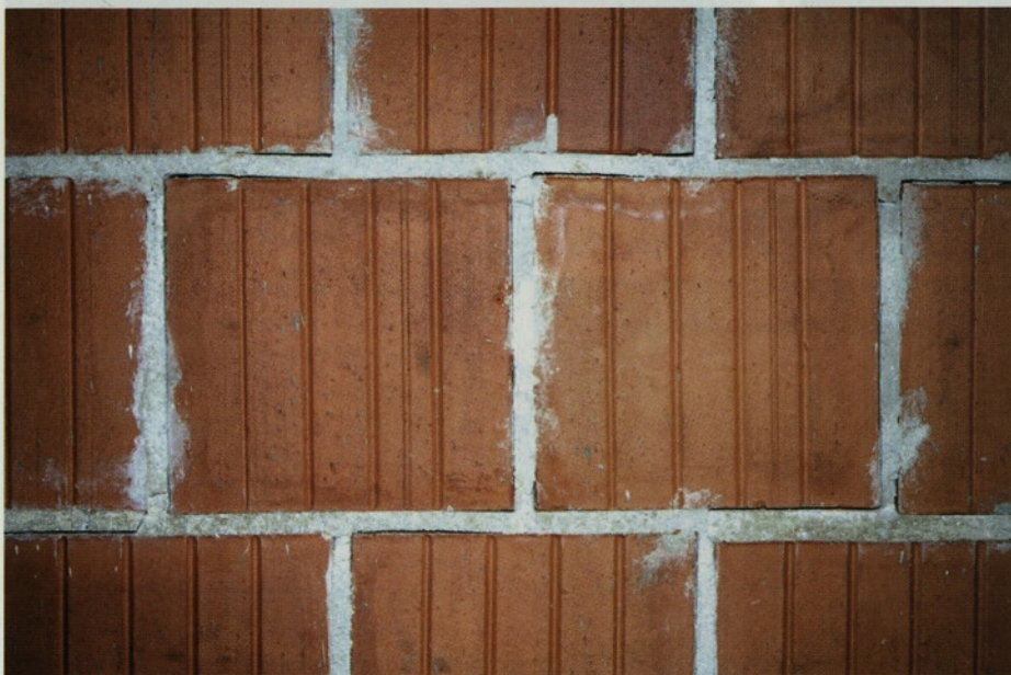
Slika 8 • Zid BNW1: detajl vrtenja posameznih zidakov pri večjih vodoravnih pomikih zidu pri predobremenitvi \sigma_u/f_k = 0,14
