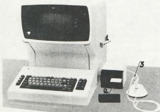
1. varnostna ključavnica - električno varovanje; 2. čitalec kartice s potrebnimi šiframi; 3. svetlobno pero za dodatno risanje in brisanje na ekranu
