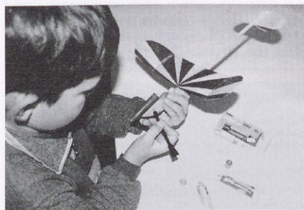
Vito Čampa ojačuje spoj pri žičnem vodilu na modelu raketoplane z epoksidnim lepilom UHU plus schnellfest.
