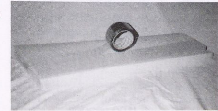
Krilo prekrivamo z lepilnim trakom od zadnjega roba proti sprednjemu.
