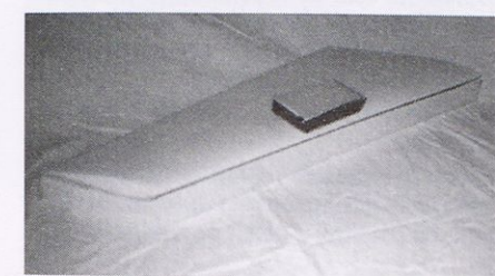
Krilo najlaže zbrusimo tako, da ga položimo na odrezani del.
