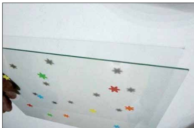
Slika 10: Steklena plošča z nalepkami rožic na razdalji 10 cm od zaslona – križno svetilo.
