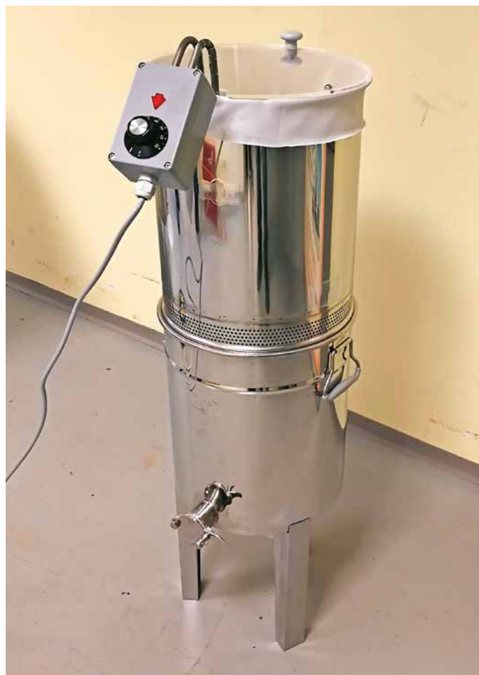
Naprava za utekočinjanje medu
