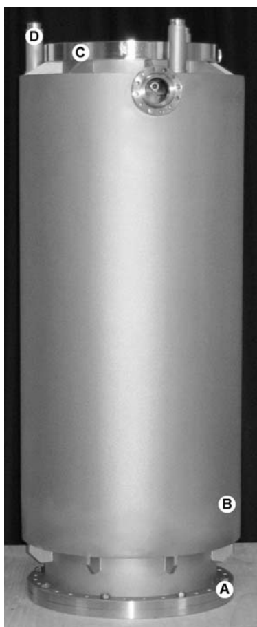
Slika 3: Nosilni del kriostata s dušikovo posodo: A) spodnja prirobnica za pritrnitev kriostata na sistem, B) nosilni plašč, C) zgornja prirobnica za pritrnitev helijevega dela kriostata in D) tri cevi, na katerih visi dušikova posoda
