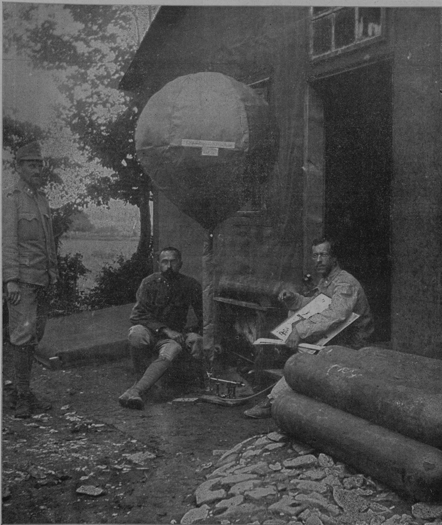
Pred zrakoplovsko pisarno: Polnitev poskusnega balona s plinom. Na desni na tleh posode z vodikom.
