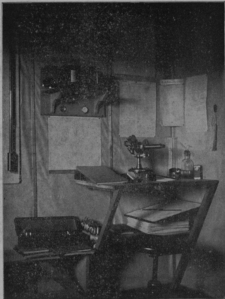
V pisarni zrakoplovske postaje: Na steni tlakomer, barograf s tabelami. Na mizi theodolit in vetromer. Na klopi vlagomer.
