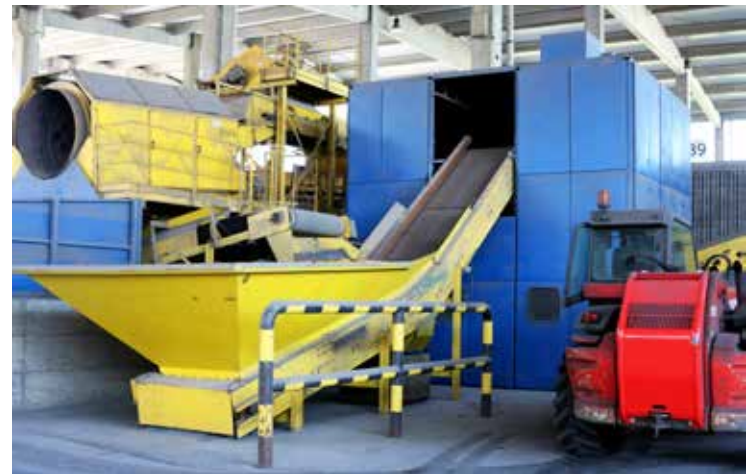
Stroj za mehansko odstranjevanje nečistoč iz sekundarnega aluminija
