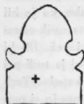
Dominikanski samostan. Pre-rez gotskega rebra prvotne samostanske cerkve.
