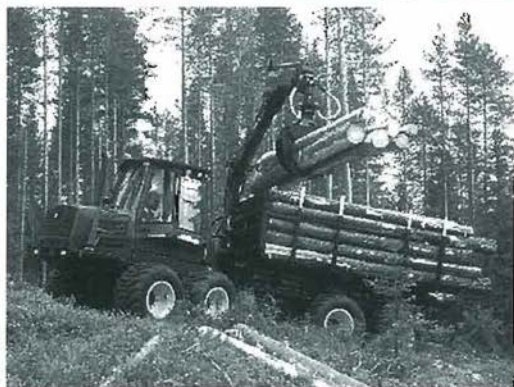
Slika 3: Stroj za spravilo lesa, forwarder (forwarder).
