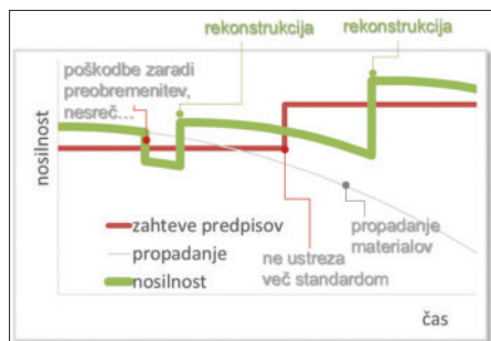
Slika 8 • Vplivi na nosilnost konstrukcije.
