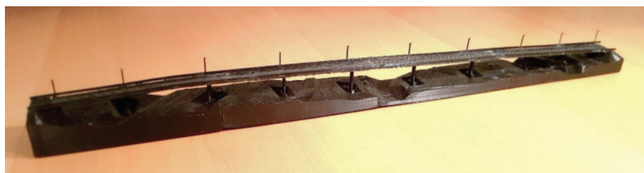
Slika 11 • Maketa nadvoza, natisnjena s 3D-tiskalnikom.
