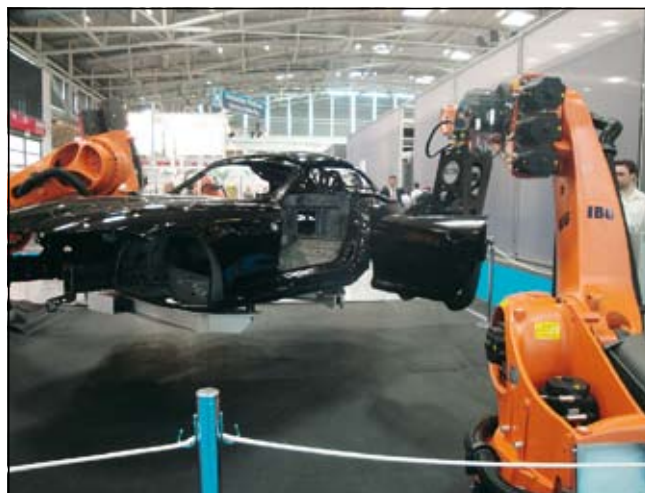
Montaža vrat, šasijo drži robot (vir: Noe)
