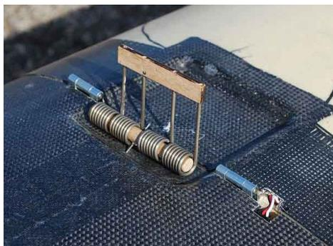
**Fig. 17.** Actuator torsion springs
