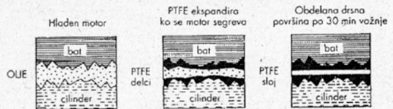
PTFE delci ekspandirajo, se vtolijo in plastificirajo, ter naredijo spolzek zoiščni sloj na porozni kovinski površini.
