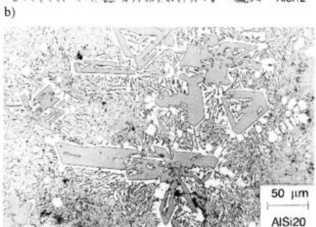
Slika 3: Mikrostrukture aluminijevih zlitin s silicijem, pov. 100x a) AlSi 5 b) AlSi12 c) AlSi20
