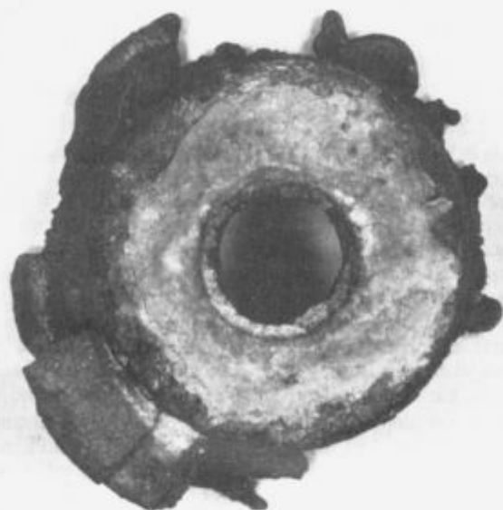
Slika 5. Primer nalepka v notranjosti drsnega zapirala.
