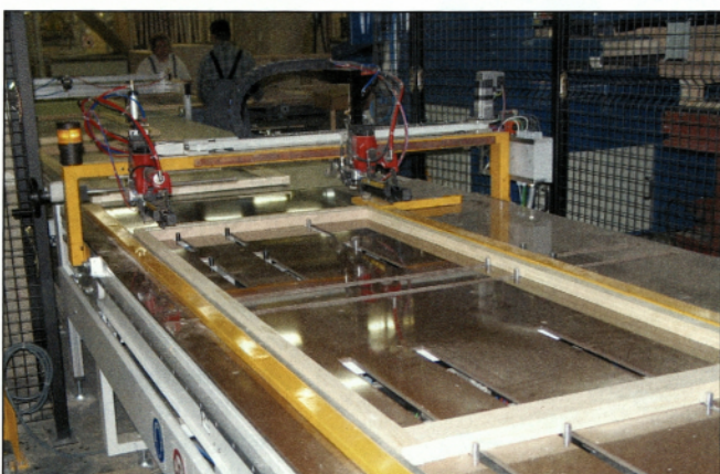
Računalniško krmiljena naprava omogoča strojno sponkanje najrazličnejših vrst okvirjev
