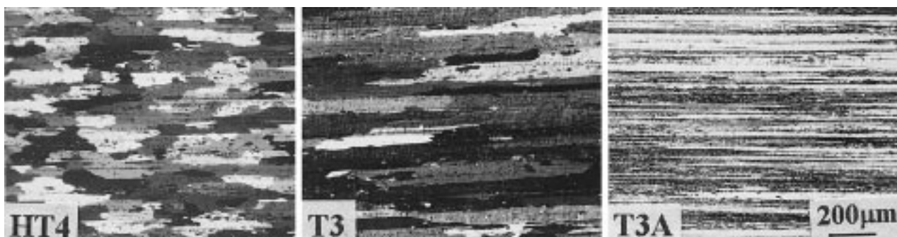
Slika 4: Mikrostruktura zlitine AlCuMgPb po toplotnih obdelavah HT4, T3 in T3A
