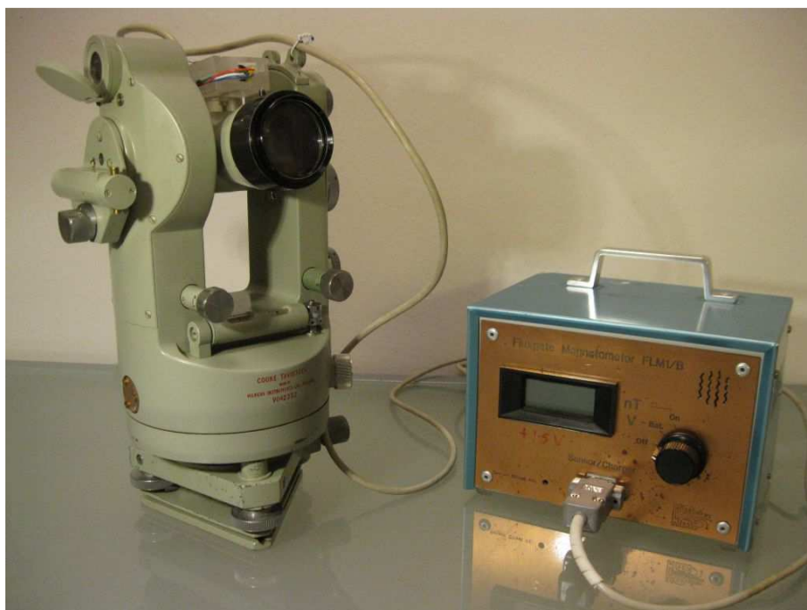
Slika 2 - Teodolitski magnetometer DI zgrajen iz nemagnetnega teodolita Cooke Tavistock (Vickers Instruments Ltd., Anglija) in enoosnega fluxgate magnetometra FLM1/B (RIM-CPG Dourbes, Belgija).
