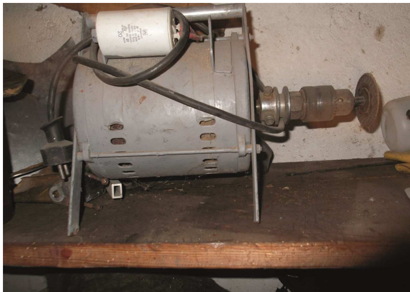
Prenosni rezkar iz motorja pralnega stroja
