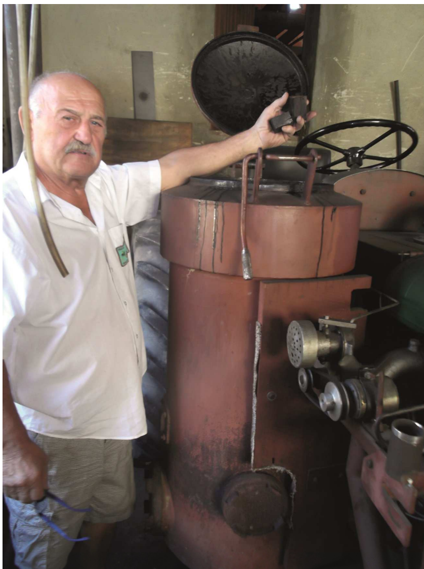
Tako na malo morajo biti pripravljena drva za peč – generator lesnega plina , kateremu plinu se učeno reče ogljikov monoksid (CO).
