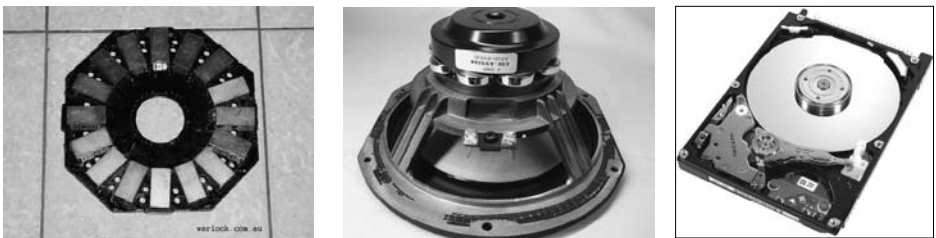
Slika 4. Primeri uporabe neodimovih magnetov: na levi sliki je del generatorja (rotorja) male vetrnice, na sredini je trdi disk osebnega računalnika in na desni zvočnik.
