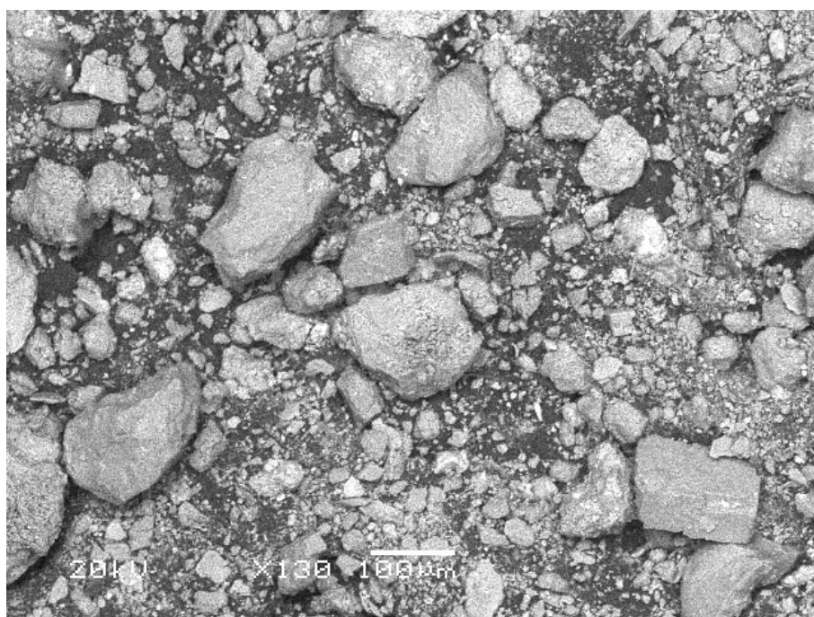
Slika 4.3: Fotografija zrn meljastega peska iz Boštanja z vrstičnim elektronskim mikroskopom pri povečavi \times 130 (foto M. Golež)
