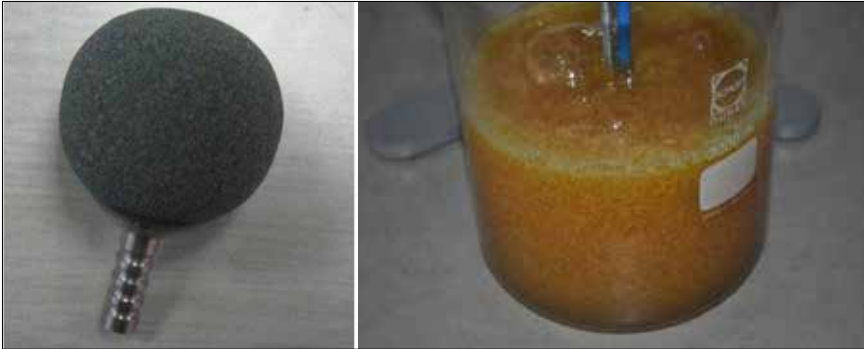
Slika 7. Zračni difuzor za penjenje olja (levo) in spenjeno olje (desno)
