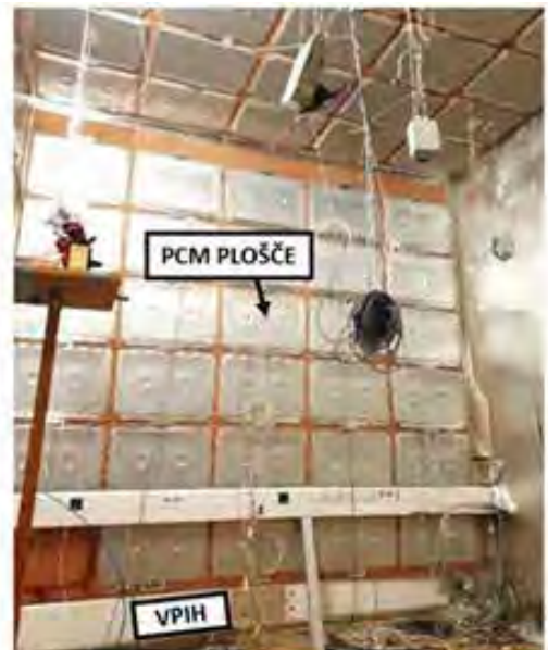
Skica laboratorijskih komor (levo) in komora, opremljena s ploščami PCM – notranja stena in strop (desno)
