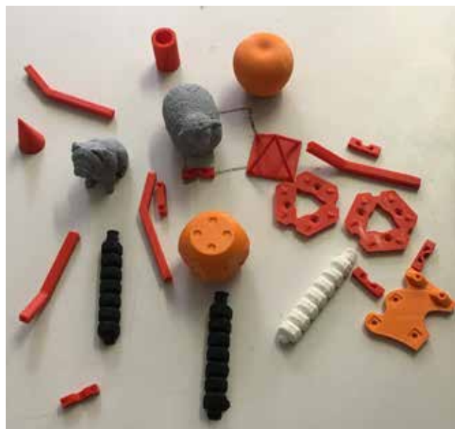
3D natisnjeni glavni sestavni deli mehkega robotskega prijemala
