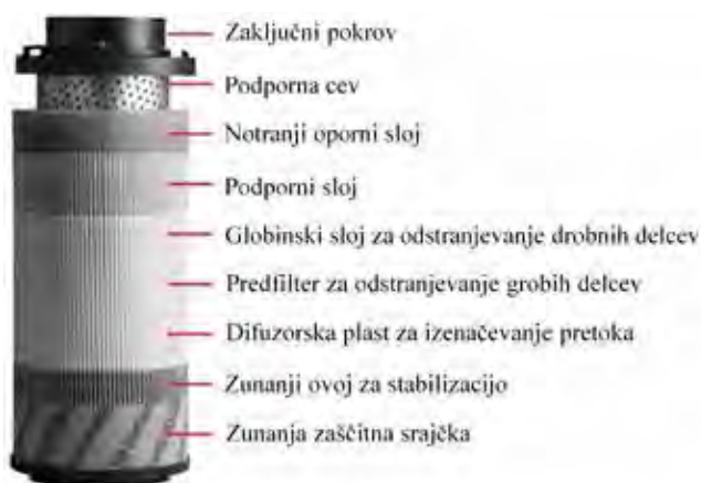
Slika 1 : Značilna zgradba filtrirnega vložka (vir slike: Hydac)
