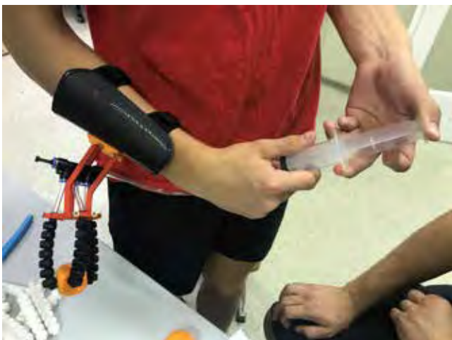
Mehko robotsko prijemalo na roki udeleženca med testiranjem
