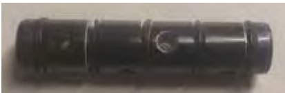
Slika 15 : Krmilni bat po 733.000 prekopih z vidnimi poškodbami tesnil in krmilnega roba
