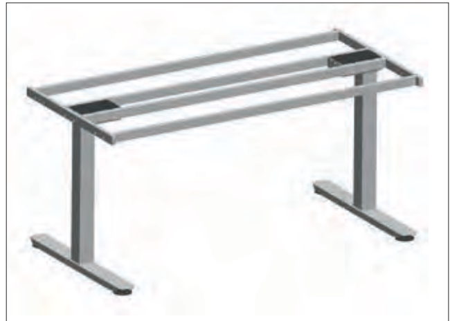
Slika 4 : Zgornji okvir z možnostjo dolžin 1600 mm, 1800 mm in 2000 mm
