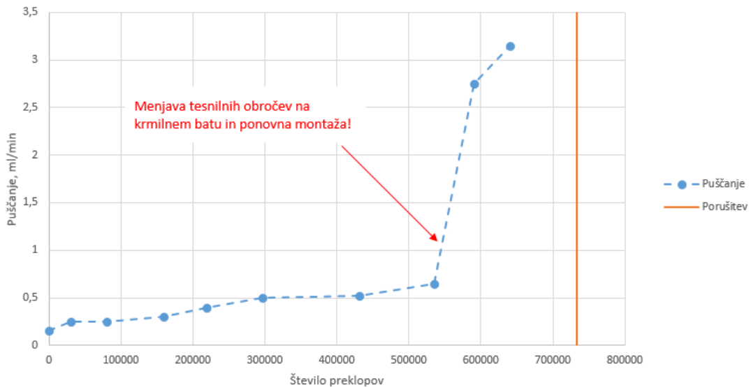
Slika 14 : Izmerjeno notranje puščanje ventila med trajnostnim testom
