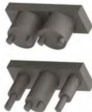
Slika 4 : Razviti montažni vložki
