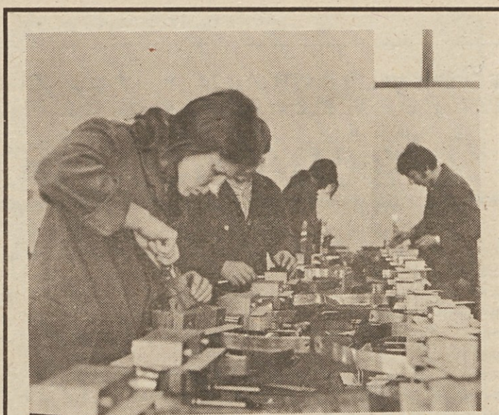
Varstroj – organizacija združenega dela Gorenje iz Lendave se je izredno uveljavila na tržišču s svojo proizvodnjo malih prenosnih in polavtomatskih varilnih aparatov v zaščitni atmosferi CO 2 . Montaža varilnih aparatov poteka še v najetih prostorih, v kratkem pa se bodo delavci preselili v nove, lastne prostore... (Foto: A. Ulaga)
