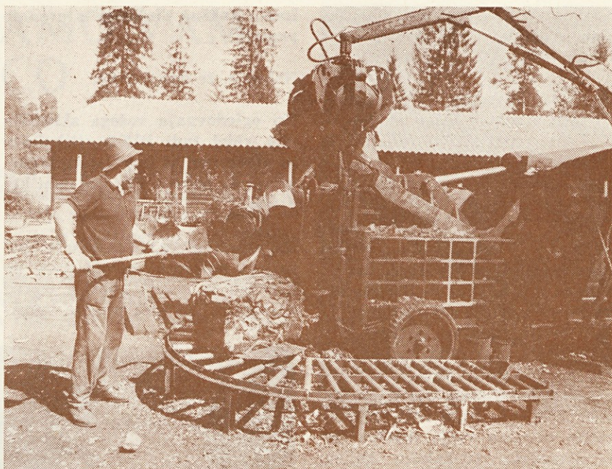
Paket stisnjene pločevine pride iz stiskalnice in se popelje po tekočem valjčnem traku navzdol
