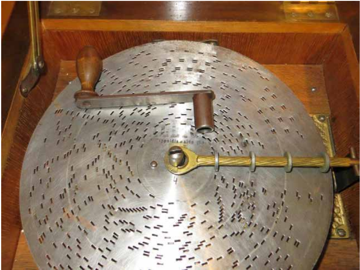
Detajl: kovinski disk z ročico, povezano z navijalnim mehanizmom, foto: Brane Lamut.
