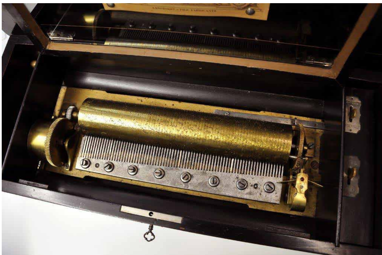
Glasbena skrinjica s cilindričnim valjem, detajl z mehanizmom, foto: Nina Mertik.
