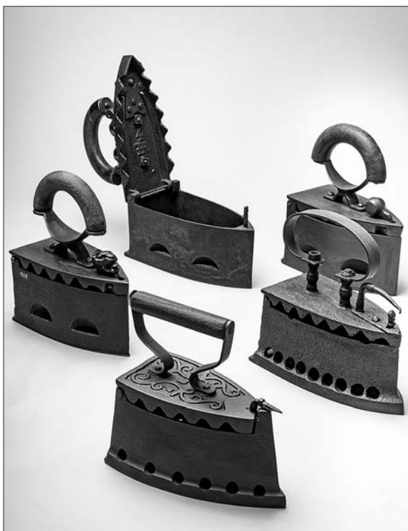
Gladenje oblačil sega v prazgodovinska obdobja, množičen pojav likalnikov in s tem likanja pa v zadnjih dvesto let. Glede na način segrevanja likalne ploskve na likalniku poznamo likalnike na oglje, z likalnim železom, nasadilne likalnike in krojaške likalnike (foto: Borut Peterlin, 2021).
