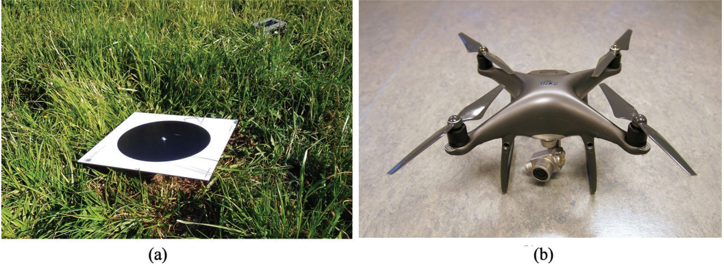
Slika 1: Primer signalizirane oslonilne točke (a) in uporabljeni letalnik DJI Phantom 4 Pro (b).
