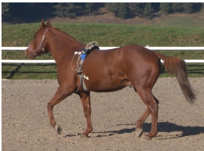
Slika 3: Nameščen lonžirni pas s telemetričnim aparatom Televet 100 med izvajanjem izbrane fizične aktivnosti (fotografija Mojca Bohar Topolovec)
