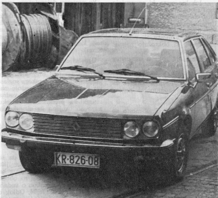
Za potrebe delovne organizacije je bil pred nedavnim nabavljen osebni avtomobil Renault 30 TS. Vozilo ima 2664 kubični motor z močjo 128 KS, dvokrožni zavorni sistem, servo napravo in sodobno izvedbo ostalih sklopov avtomobila
