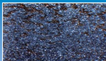
Površina, peskana s steklenimi kroglicami – vidni ostanki neobdelane površine
