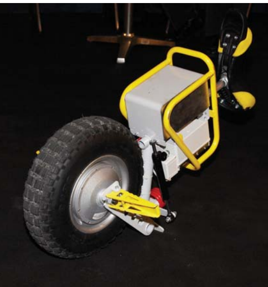
Enokolo – inovacija: sistem za krmiljenje električnega enokolesa
