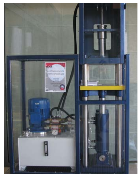
Stroj za preizkušanje orodij za brizganje plastike (avtor Matej Kuhar, Mentor: dr. Igor Drstvenšek, izdelano v sodelovanju s podjetjem Tehcenter s Ptuj)
