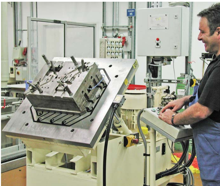
Slika 5: Aplikacijski tehnik Antonio Cassaro premika magnetno vpenjalno ploščo s polovico orodja na navlečno pripravo.
