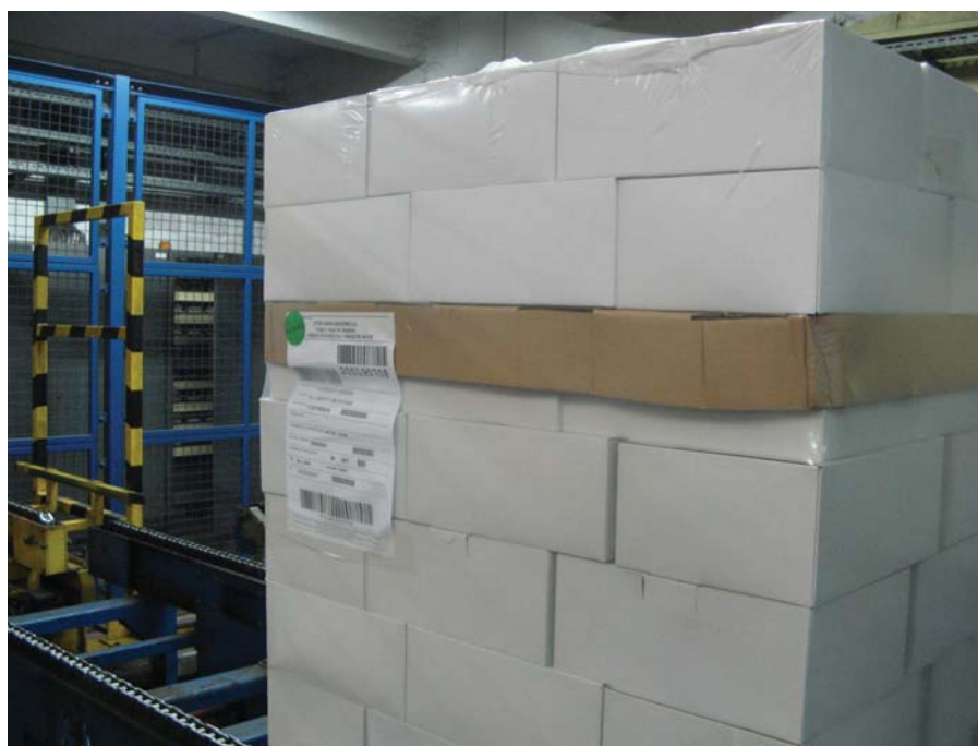
Slika 3: Pakiranje vnaša dodatne omejitve za namestitev paletnega lista.
