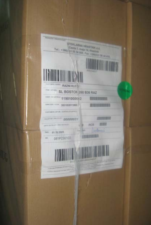
Slika 4: Učinkovita (trikratna) oznaka palete se uspešno izogne gubam.
