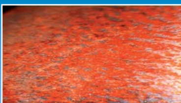
Erodirana površina – martenzitna struktura
