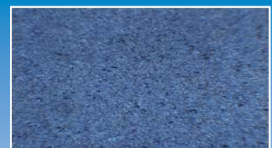
Površina, peskana s HGH-jevo peskalno napravo in peski – površina je popolnoma čista
