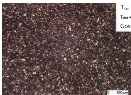
Mikrostruktura za Ti99 (povečava 15 : 1)
