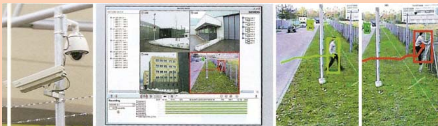
Nadzorni sistem Sistore CX EDS odkriva vsiljivca z analizo obrazcev njegovega gibanja (desno), posnetega s kamero (levo), in ga spremlja na zaslonu za več slik (v sredini).
