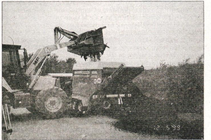
Iz kompostnih kupov predelano zmes vozijo na stroj za sejanje, ki izloči dober kompost za gnojenje vrtov in njiv.
