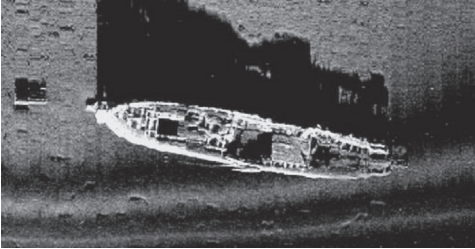
Slika 5: Primer podatkov, dobljenih s side-scanom. Na sliki je na globini 76 m potopljena ladja, ki se nahaja v zalivu Elliot Bay, Washington ( www.innerspaceexploration.com ).
