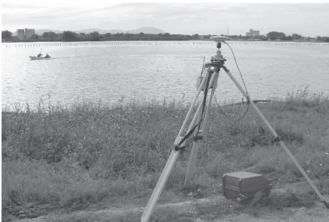
Slika 8: Uporaba GPS-tehnologije pri merjenju rečnih profilov na akumulacijskem bazenu HE Formin. Uporabljen je par RTK GPS-sprejemnikov Leica GX 1230.
