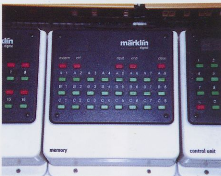
S pomočjo spominske enote Memory, ki dopolnjuje centralo in Keyboard, lahko vlaki vozijo po delno naprej določenem voznem redu.
