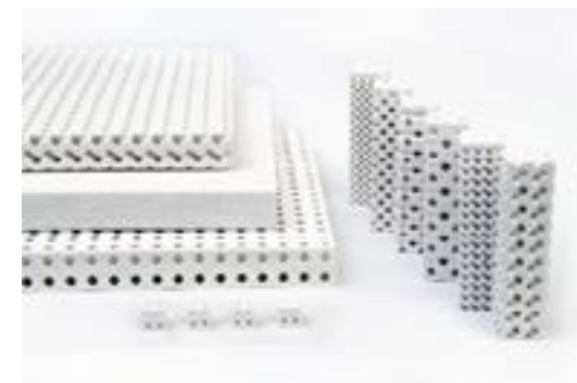
Slika 15: Primeri različnih struktur, natisnjeni s tiskalnikom Zprinter 310, s sadro kot prekurzorjem in vodo kot aktivatorjem, fotografija: Arhiv ZAG
