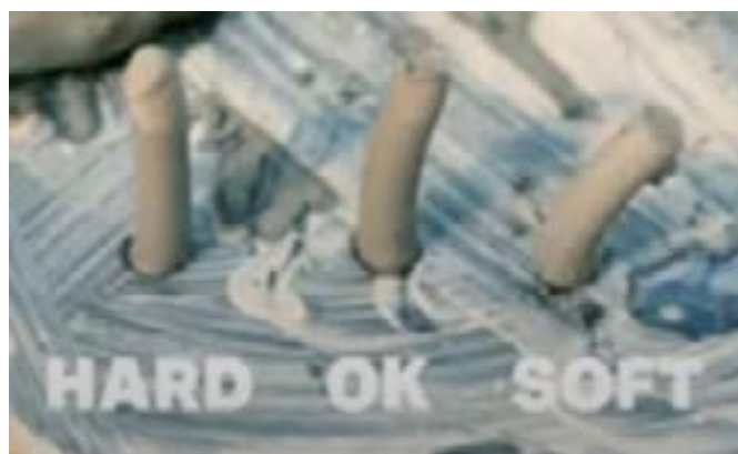
Slika 16: Preprost ekstruzijski test z brizgalko, fotografija: Arhiv ZAG
