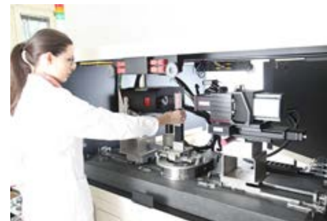
Slika 11: CT scaner na Zavodu za gradbeništvo Slovenije, fotografija: Arhiv ZAG
