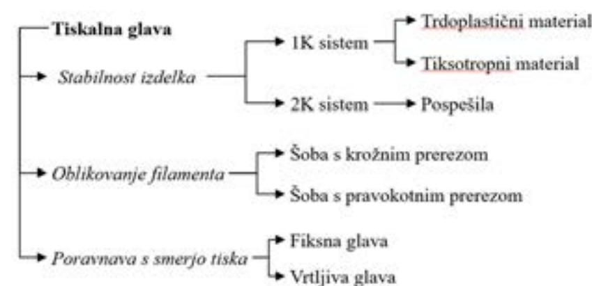
Slika 10: Strategija tiskanja in izbira elementov tiskalne glave.
