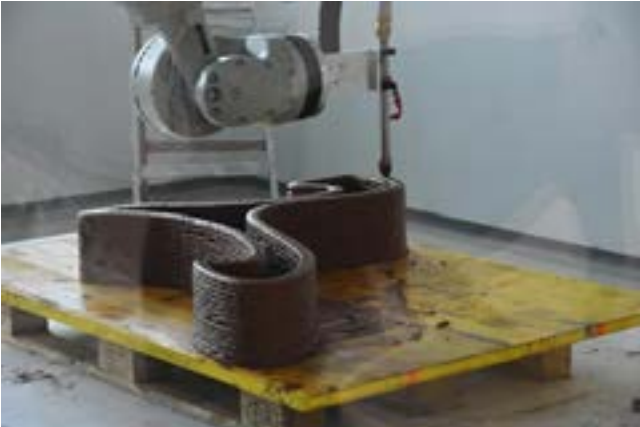
Slika 18: Tisk stola z ekstruzijskim tiskalnikom Kuka in cementnim materialom, fotografija: Arhiv ZAG
