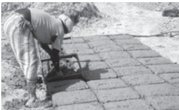
Slika 10: Postopek izdelovanja ilovnatih zidakov z lesenimi modeli. (Foto: B. Juvanec)
