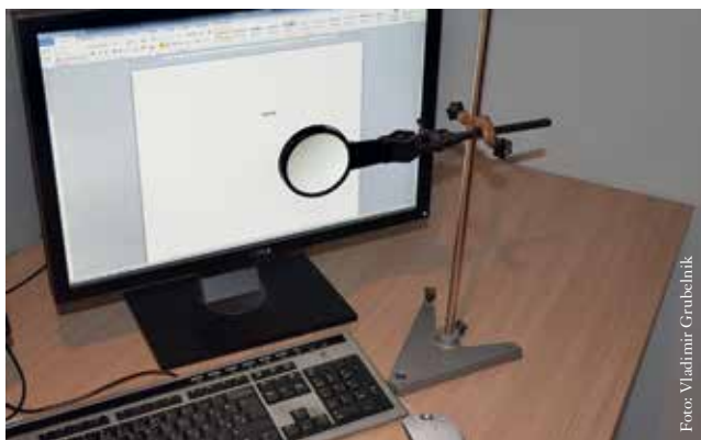
Slika 4: Lečo postavimo nekoliko dlje od računalniškega zaslona, kot je njena goriščna razdalja.
