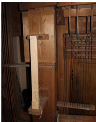
Zagorje ob Savi – zajemalni klinasti meh (levo); izravnalni meh (desno).
