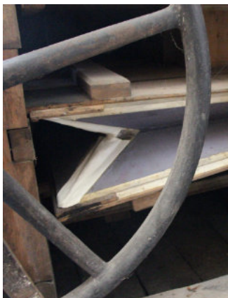
Zagorje ob Savi – zajemalni klinasti meh (levo); izravnalni meh (desno).
