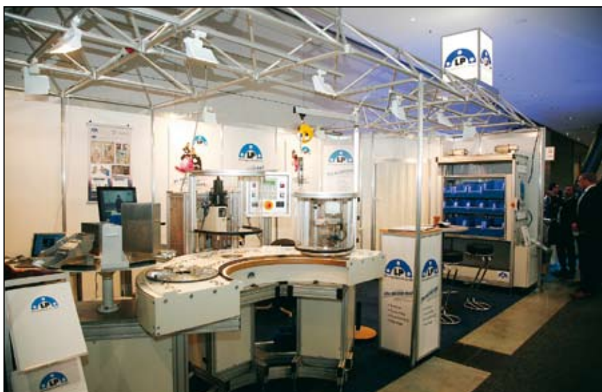
Tok materiala po načelu kos po kos z nosilcem za več izdelkov. V ozadju omara z dvignimi policami za prilagoditev višine za jemanje iz zabojev na policah.
