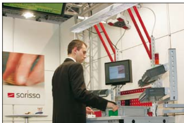
Prostorsko sledenje gibom s sistemom LPS (local positioning system) podjetja Sarissa
