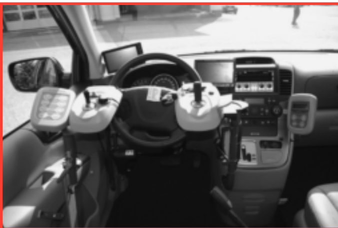
Slika 3: Elektronski sistem za upravljanje zavore in plina z levo ročico (pomik naprej – zavora, pomik nazaj – plin) in volana z desno ročico. Senzorska stikala ob ročicah omogočajo upravljanje menjalnika, smernikov, luči itd.
