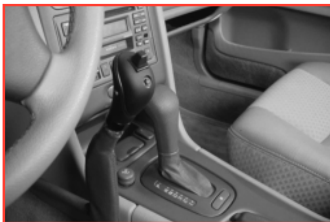
Slika 1: Mehanska naprava – ročica (desno ob volanu) za ročno upravljanje zavore in plina pri avtomobilu z avtomatskim menjalnikom.
